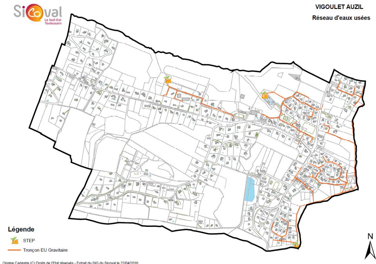
Figure 24 : Plan du réseau d'assainissement collectif (SICOVAL, 2016)
