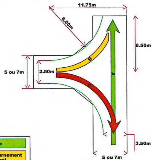
Figure 2 - Principe de retournement de type « en T »
