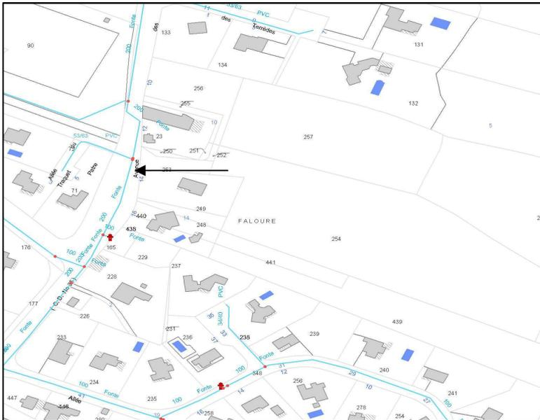
L'opération pourra être raccordée sur le réseau existant en fonte (D200 mm) situé Avenue des Côteaux. Ce réseau permettra de desservir l'opération projetée.
