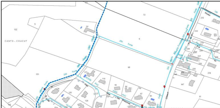
Des conduites de transport (fonte - D350 mm) et de distribution (fonte - D250 mm et D200 mm) se situent au droit et à l'intérieur de la zone en servitude. L'aménagement devra prendre en compte et intégrer au mieux la présence des canalisations. Le réseau existant permettra le raccordement des 30 à 35 logements envisagés.
